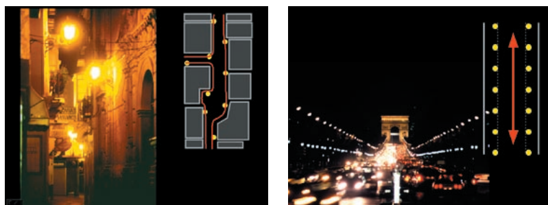
図 1.2.-2 照明の配置のルールにより夜の景観が変化する例
